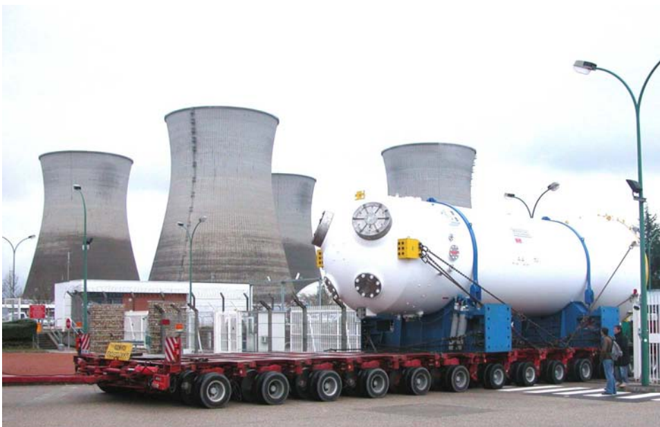
Les générateurs de vapeur neufs ont été acheminés, par convoi exceptionnel, de l'usine AREVA de Chalon-sur-Saône jusqu'à la centrale du Bugey. Chaque générateur est arrivé en deux parties pour pouvoir entrer dans le bâtiment réacteur.
